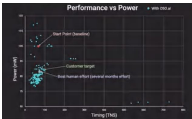
图1. Synopsys 的 DSO.ai 设计空间优化工具使用针对客户芯片设计的强化学习,远远提前于人类工程师数月才能实现的优化。
