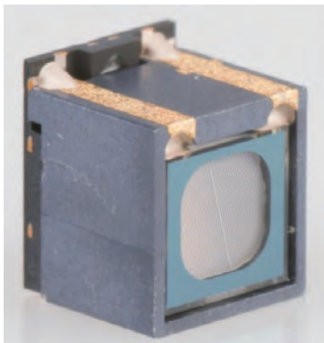
艾迈斯欧司朗的 Belago 1.1 点阵投射器包括一个红外 VCSEL, 为自动导引车 (AGV)、机器人、无人机等提供 3D 传感解决方案。(图片: 艾迈斯欧司朗)
