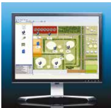
图2.网络可视性——通过网络管理软件可查看与无线网络健康状况相关的重要信息,例如 Emerson Process Management 的这款 SNAP-ON 软件实用工具。
