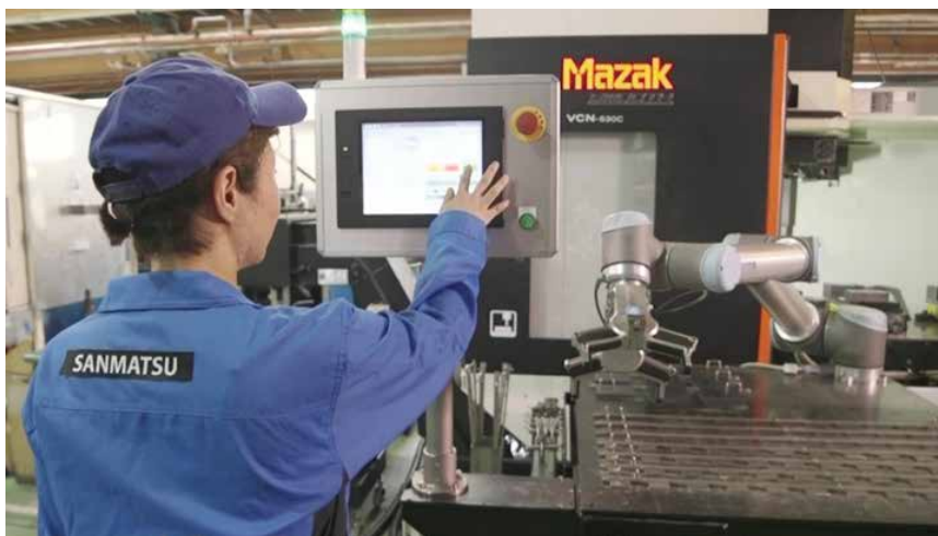
图：为SANMATSU公司的生产加工中心配备的高效的OnRobotRG6电动夹持器，易于操作，提升效率。
