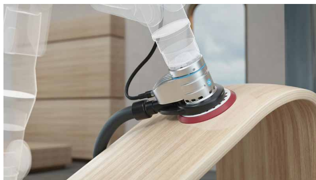
图：OnRobot Sander支持平坦和各类弯曲不均匀的几何零件的砂光工作。
