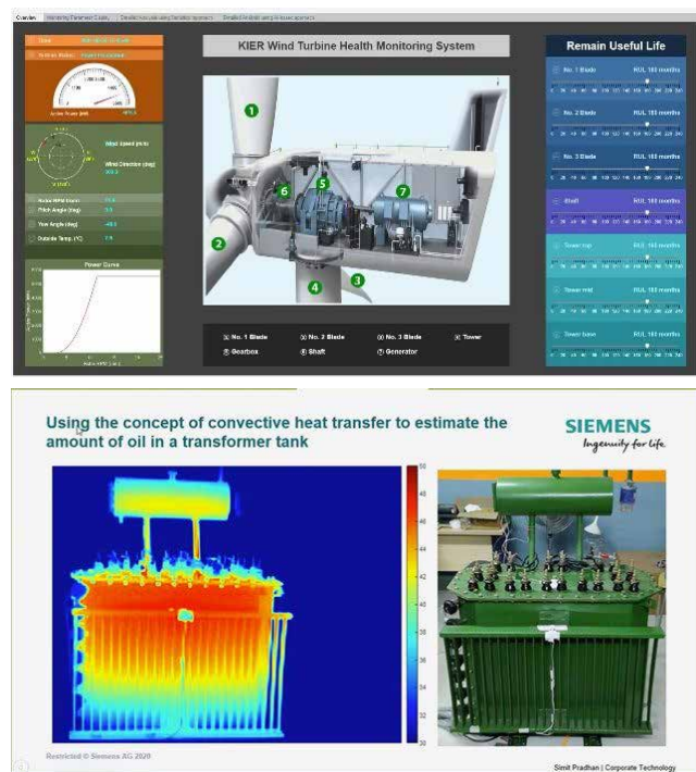
图4. KIER风力发电机健康监测系统Siemens利用对流换热的概念估计变压器油箱。
